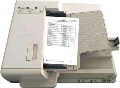
A silver Epson flatbed scanner with a paper input tray at the bottom and a glass scanning surface with a black frame at the top. A document is shown on the glass surface. | En paysage (peu importe comment sont placés l'en-tête et le pied de page) avec le côté recto visible et le côté verso non visible (le scanner scanne par le haut). |
